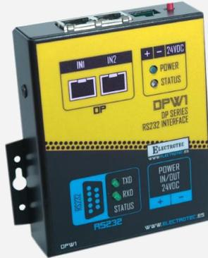
**Módulo RS232C.** se caracteriza por contar con procesador interno capaz de gestionar la lectura de datos en RS232C y escritura de datos al receptor RS232C. Es totalmente transparente a las órdenes de lectura y escritura, esto facilita al programador el desarrollo del software de aplicación.
