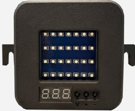
**Indicador luminoso LEDs RGB,** Este dispositivo dispone de 28 Leds rgb que permiten iluminar el hueco o compartimento de la estantería. Incorpora un display que sirve para información y setup, además también incluye tres pulsadores para la configuración del dispositivo.
